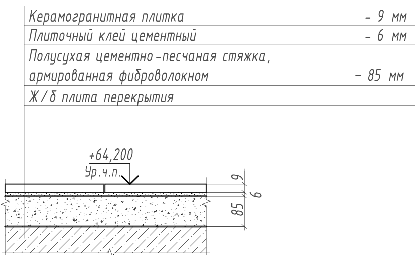
Узел устройства пола
