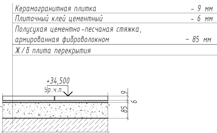
Узел устройства пола
