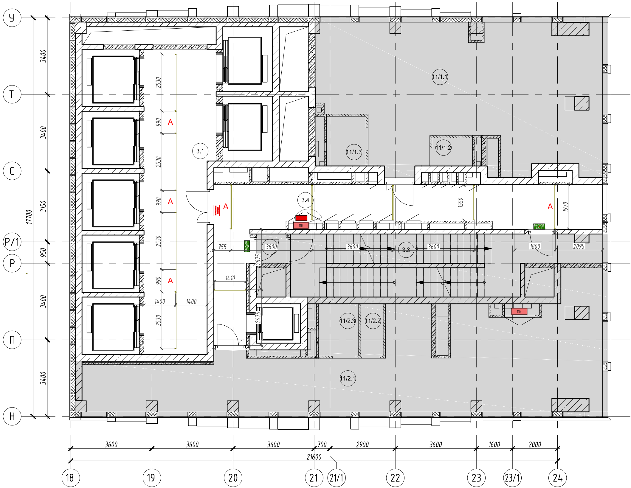
План расстановки осветительных приборов. М 1:100
