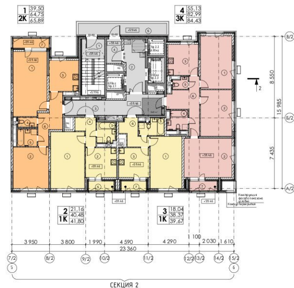
План 19 этажа на отм. +59.46 (М 1:200) Корпус 2
