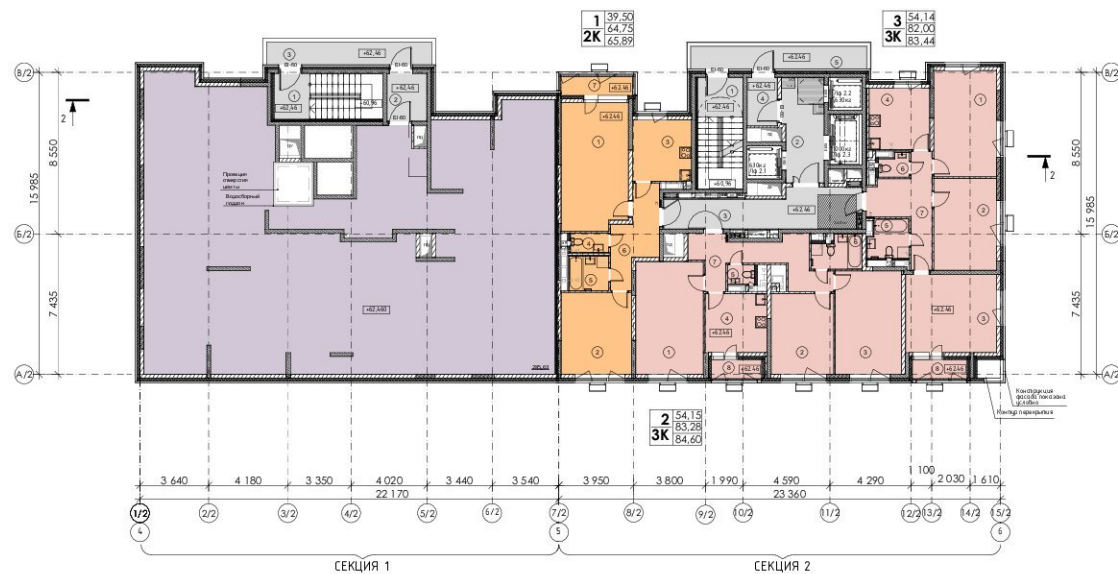
План технического пространства на отм. +62.46 (М 1:200) Корпус 2
