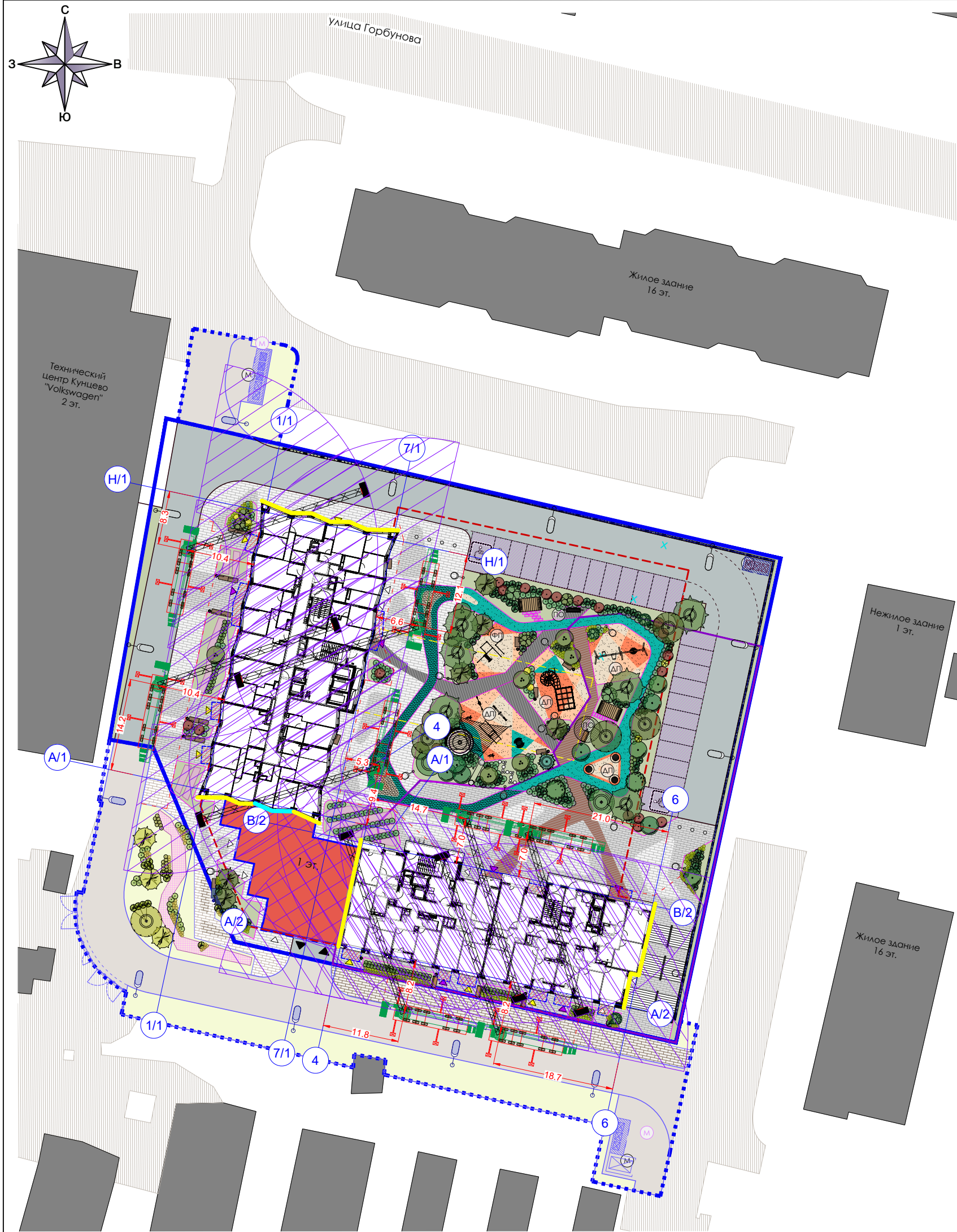
Схема № 20 Оптимальные места установки и позиции для работы по фасадам объекта коленчато-телескопического подъемника Bronto Skylift F 90 HLA. Уровень 28-го этажа Корпуса 1 и 19-20-го этажей Корпуса 2
