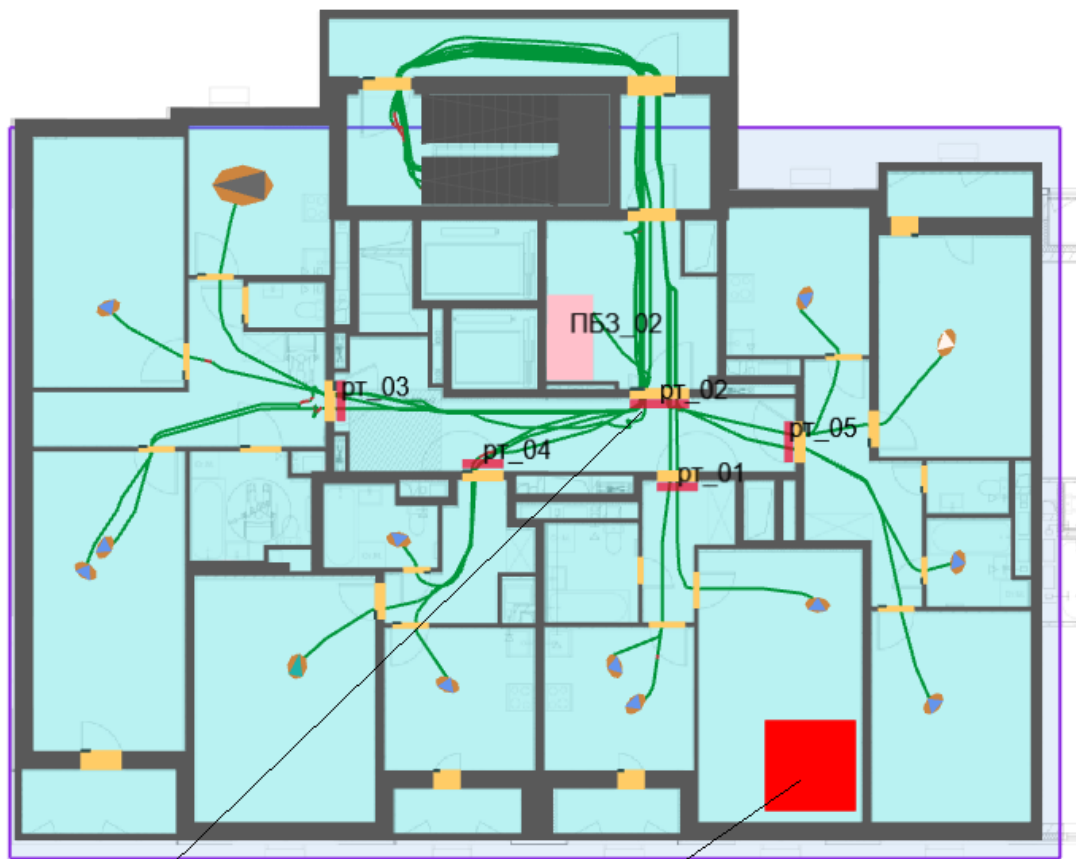
Рисунок 43 – План 2-го этажа и нанесенная на него расчетная (принципиальная) схема эвакуации
