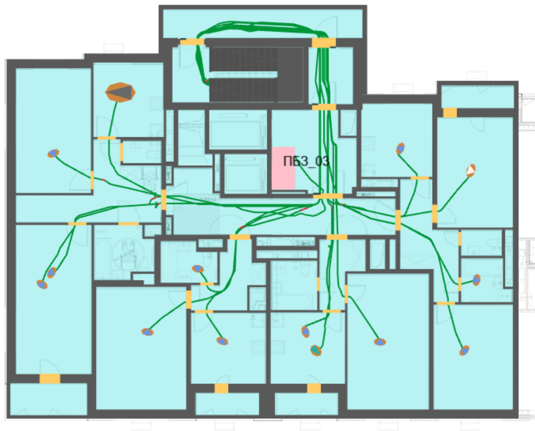
Рисунок 44 – План 3-го этажа и нанесенная на него расчетная (принципиальная) схема эвакуации
