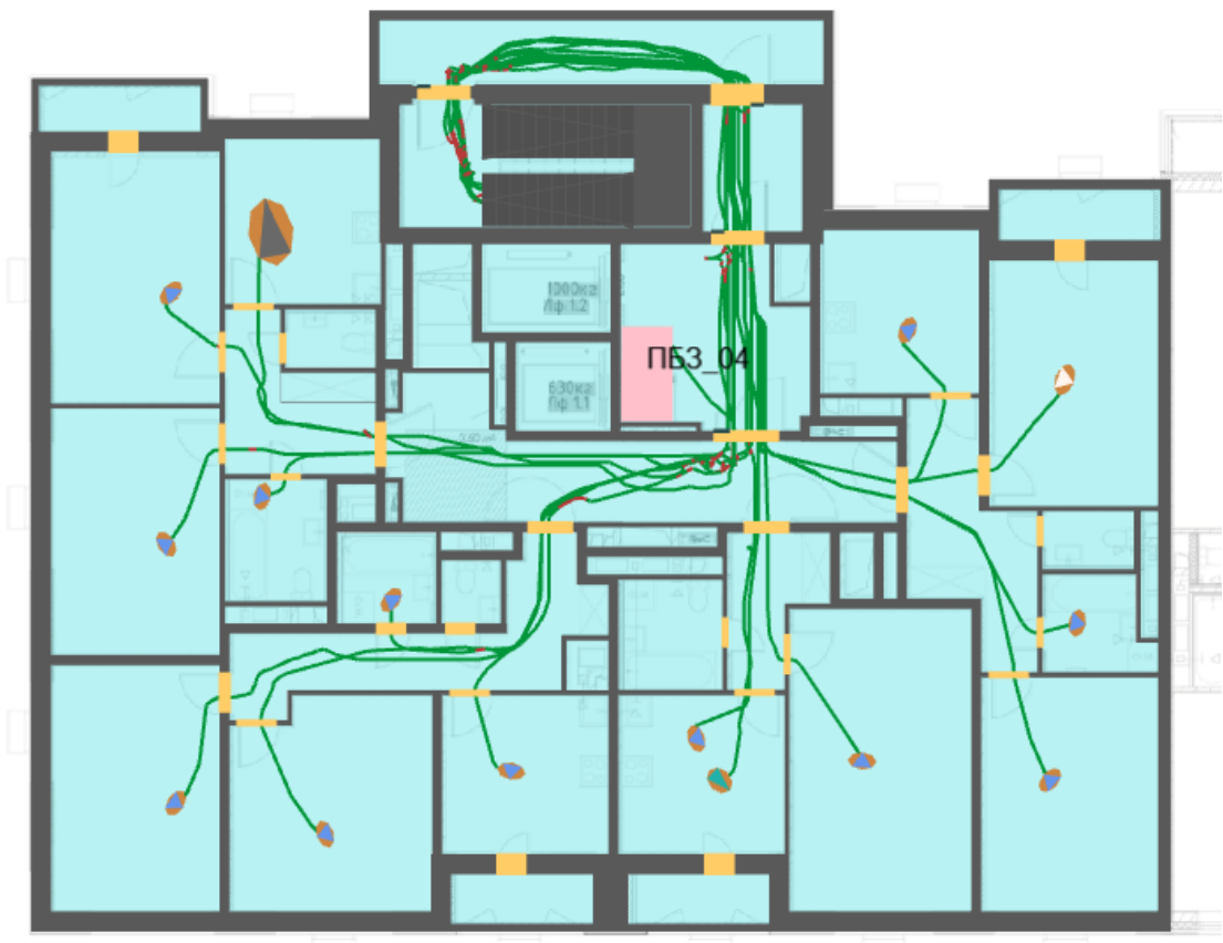
Рисунок 45 – План 4-11-го типового этажа и нанесенная на него расчетная (принципиальная) схема эвакуации
