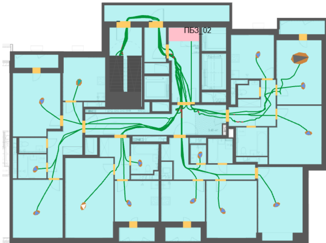
Рисунок 89 – План 2-4-го, 6-7го типового этажа и нанесенная на него расчетная (принципиальная) схема эвакуации
