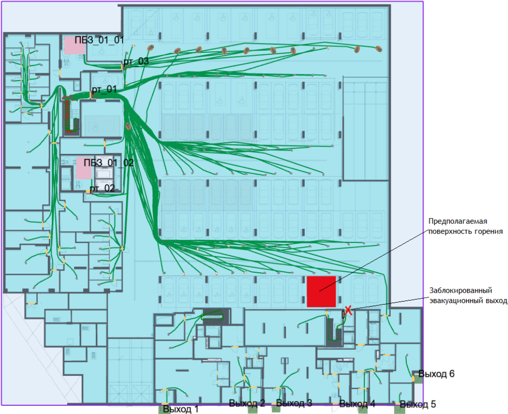
Рисунок 29 – План «минус» 1-го этажа и нанесенная на него расчетная (принципиальная) схема эвакуации
