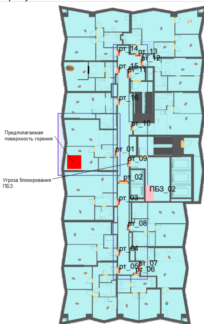
Рисунок 32 – Компьютерная модель 2-го этажа с предполагаемой поверхностью горения и нанесенными расчётными точками
