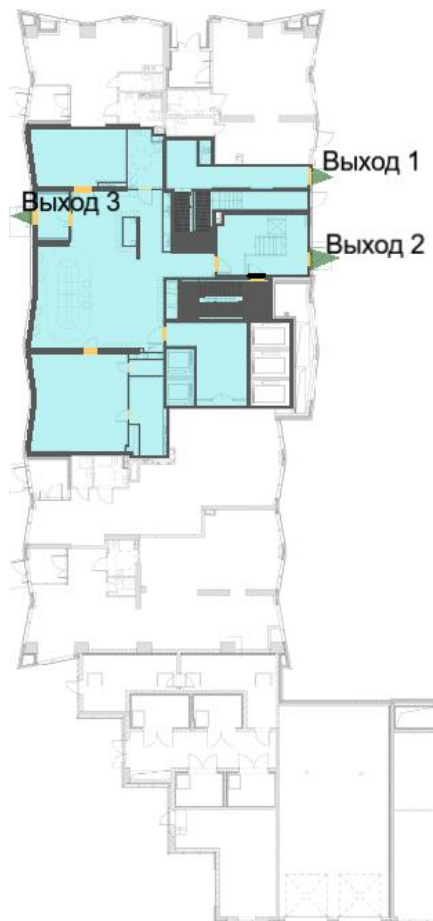
Рисунок 148 – План 1-го этажа и нанесенная на него расчетная (принципиальная) схема эвакуации
