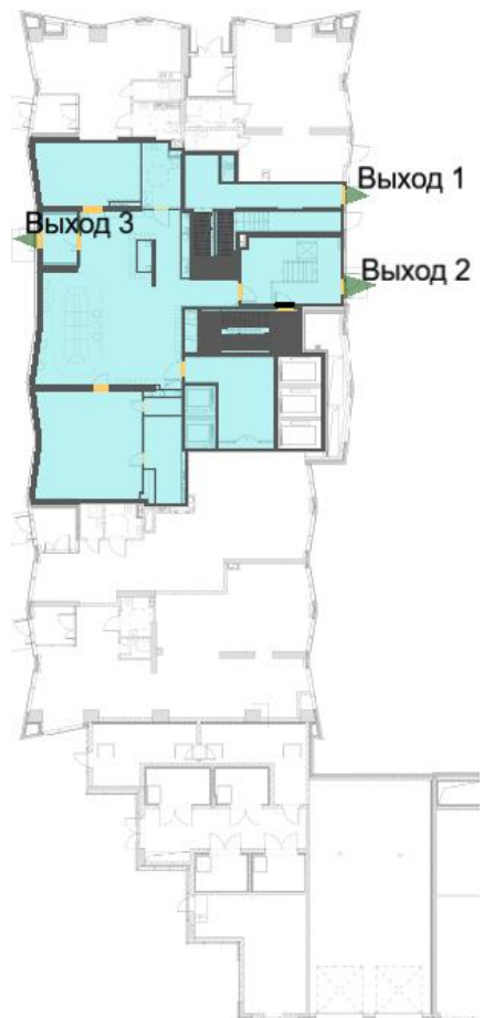
Рисунок 217 – План 1-го этажа и нанесенная на него расчетная (принципиальная) схема эвакуации
