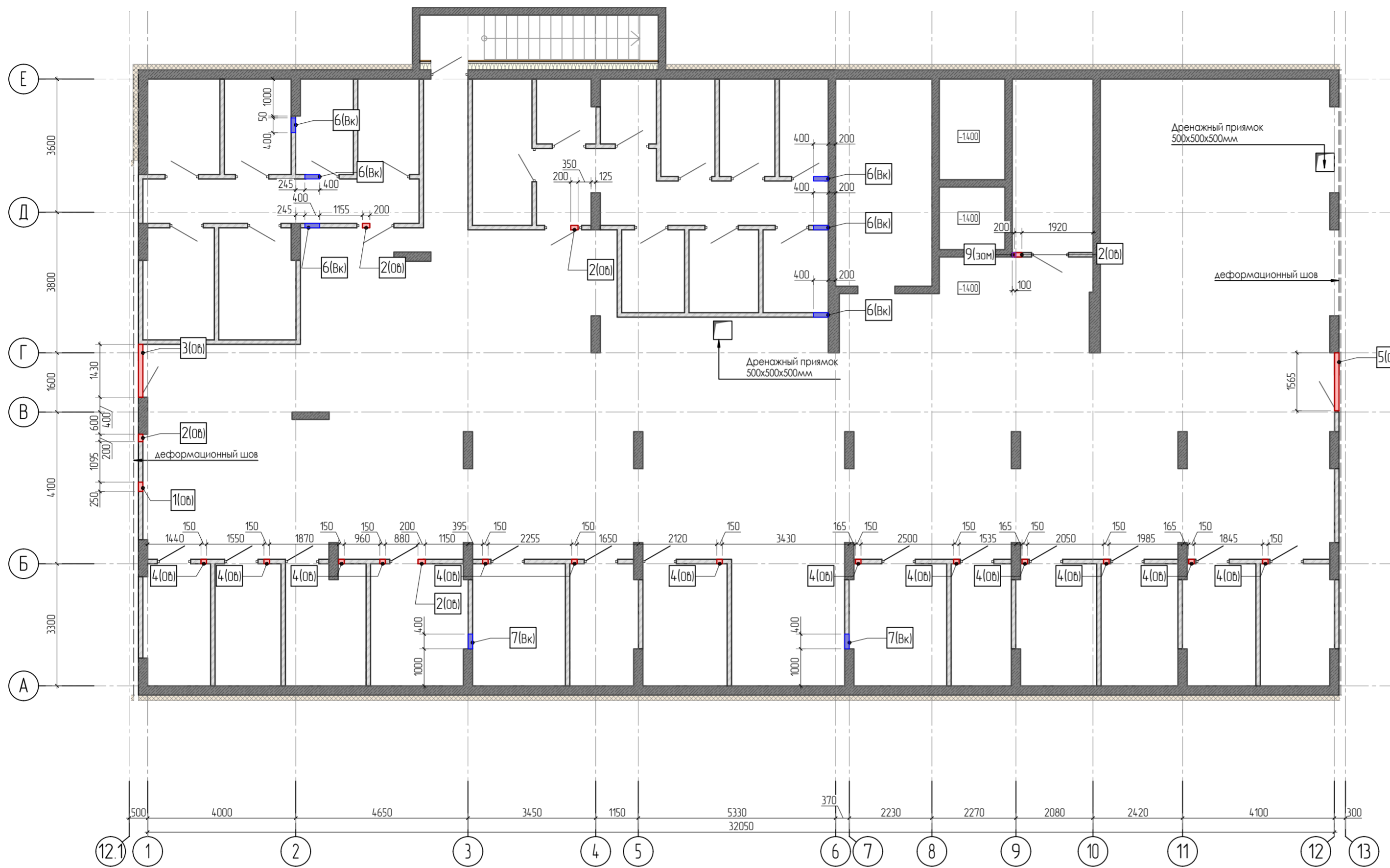
Монтажная конструкция при устройстве отверстий 10Вк
