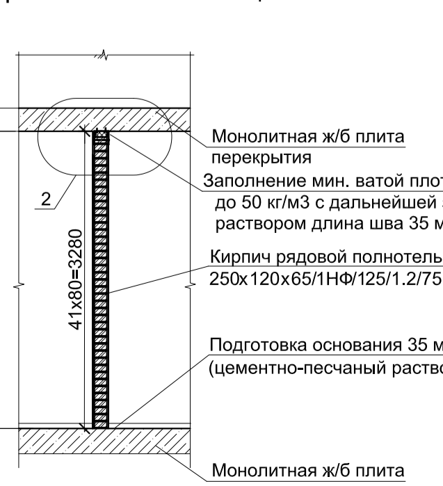
Устройство внутренних стен кирпичных стенок толщиной 250 мм
