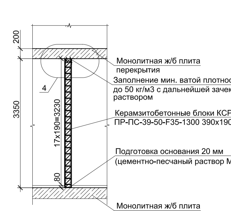
Устройство внутренних стен из керамзитобетонных блоков толщиной 190 мм
