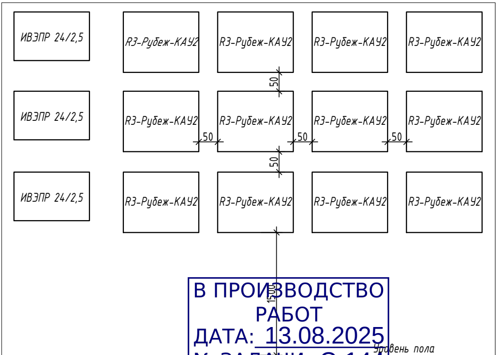
Эскиз размещения оборудования в помещении "Аппаратная СС №2 (03.12)"
