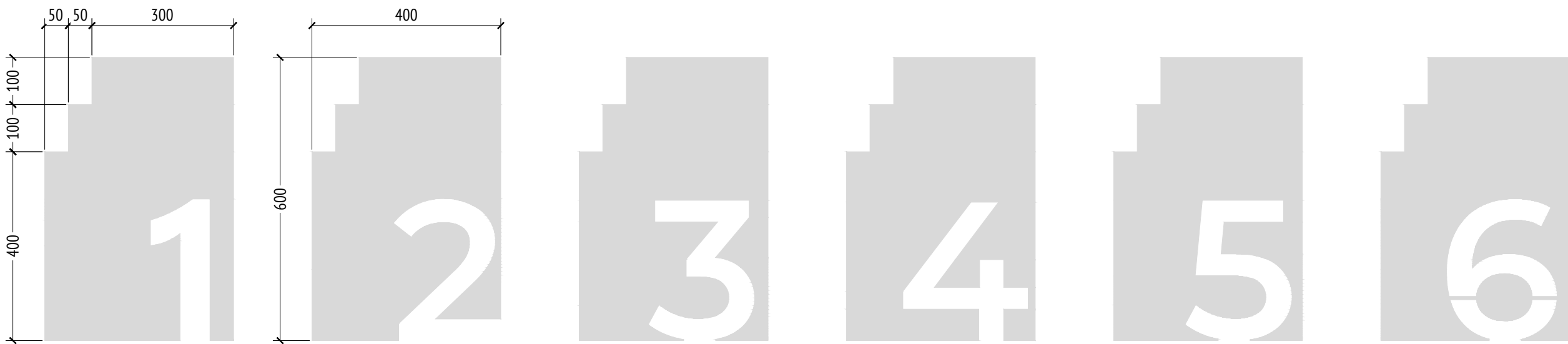
Габариты табличек с номерами корпусов М1:10
