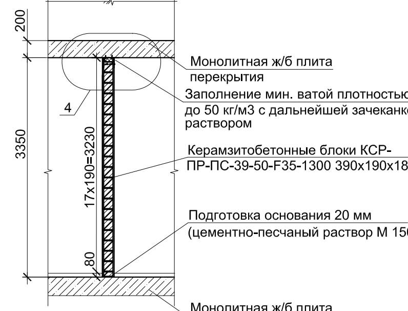
Устройство внутренних стен из керамзитобетонных блоков толщиной 190 мм
