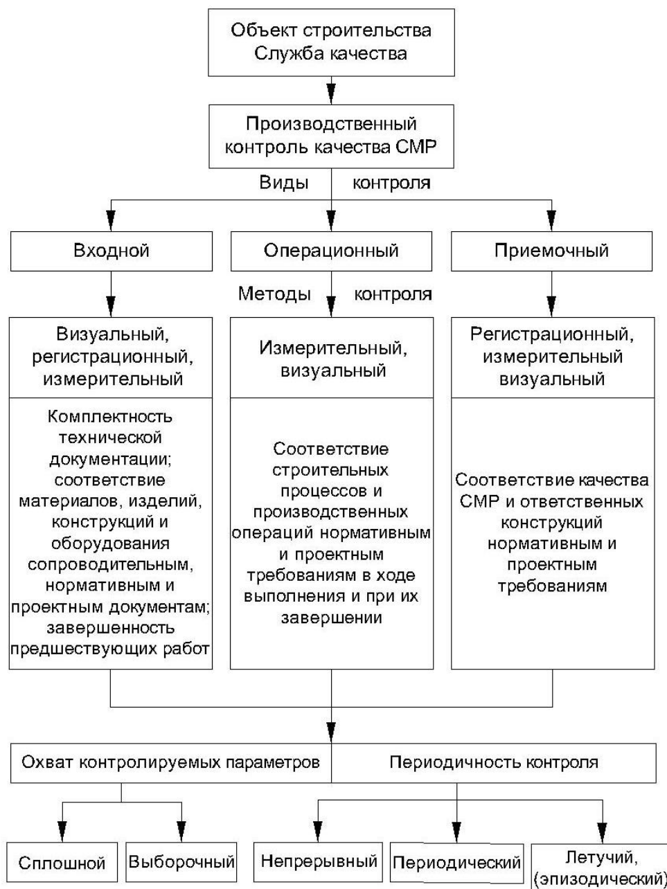
Рисунок 1. – Общая схема производственного контроля качества строительно-монтажных работ.
