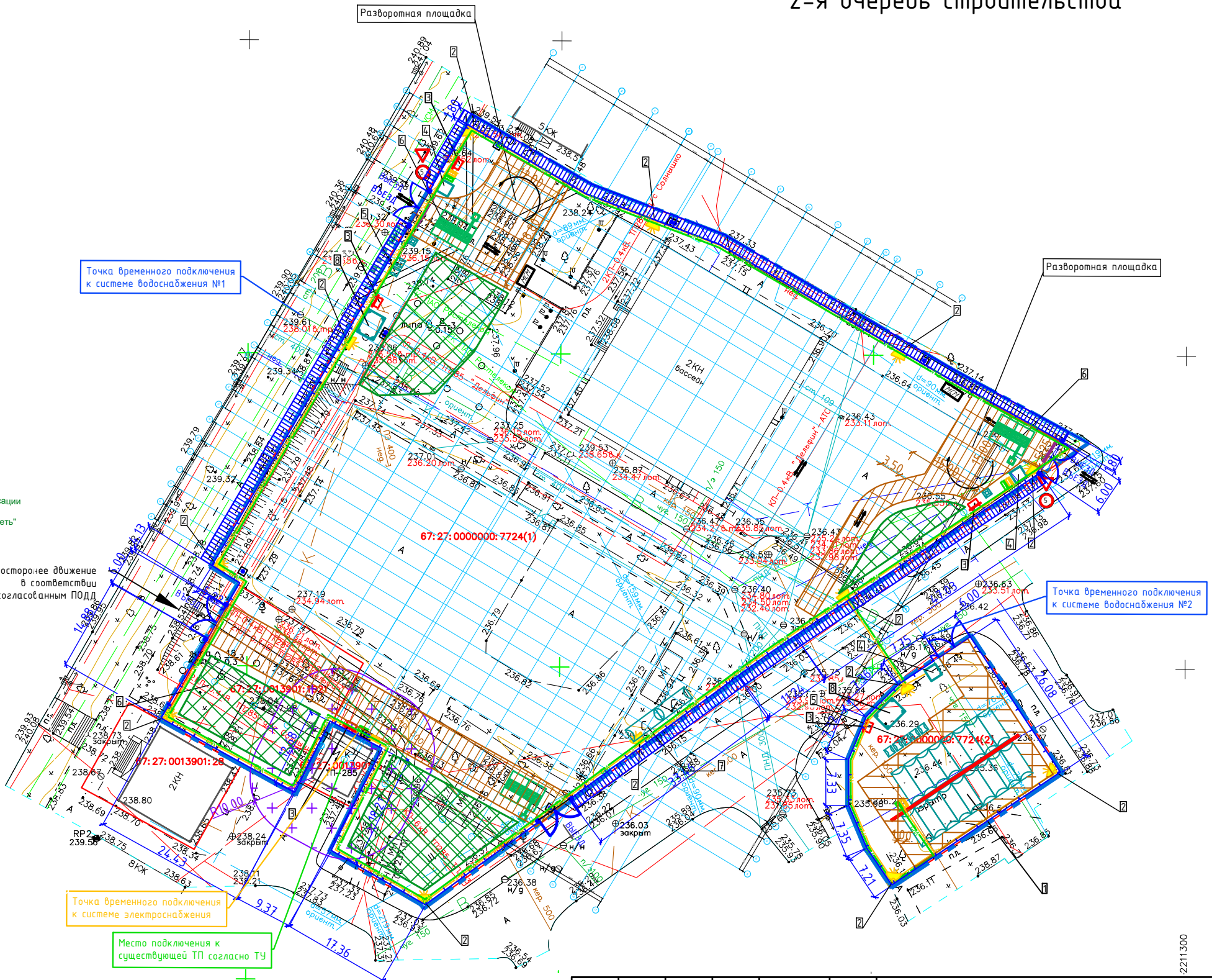
Схема движения транспортных средств на строительной площадке. 2-я очередь строительства
