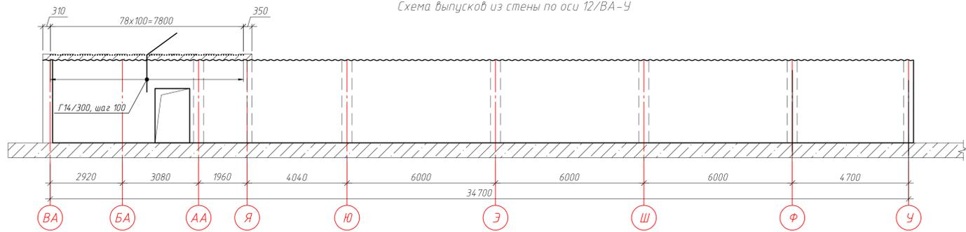
Схема установки стержней поперечной арматуры
