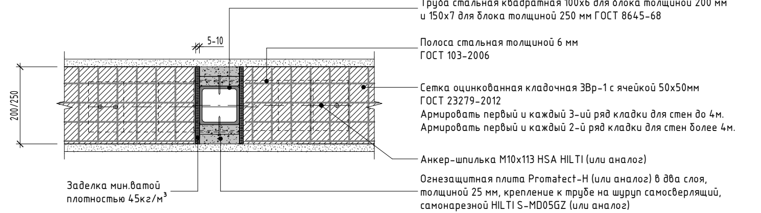
Схема усиления Т-образного соединения стен
