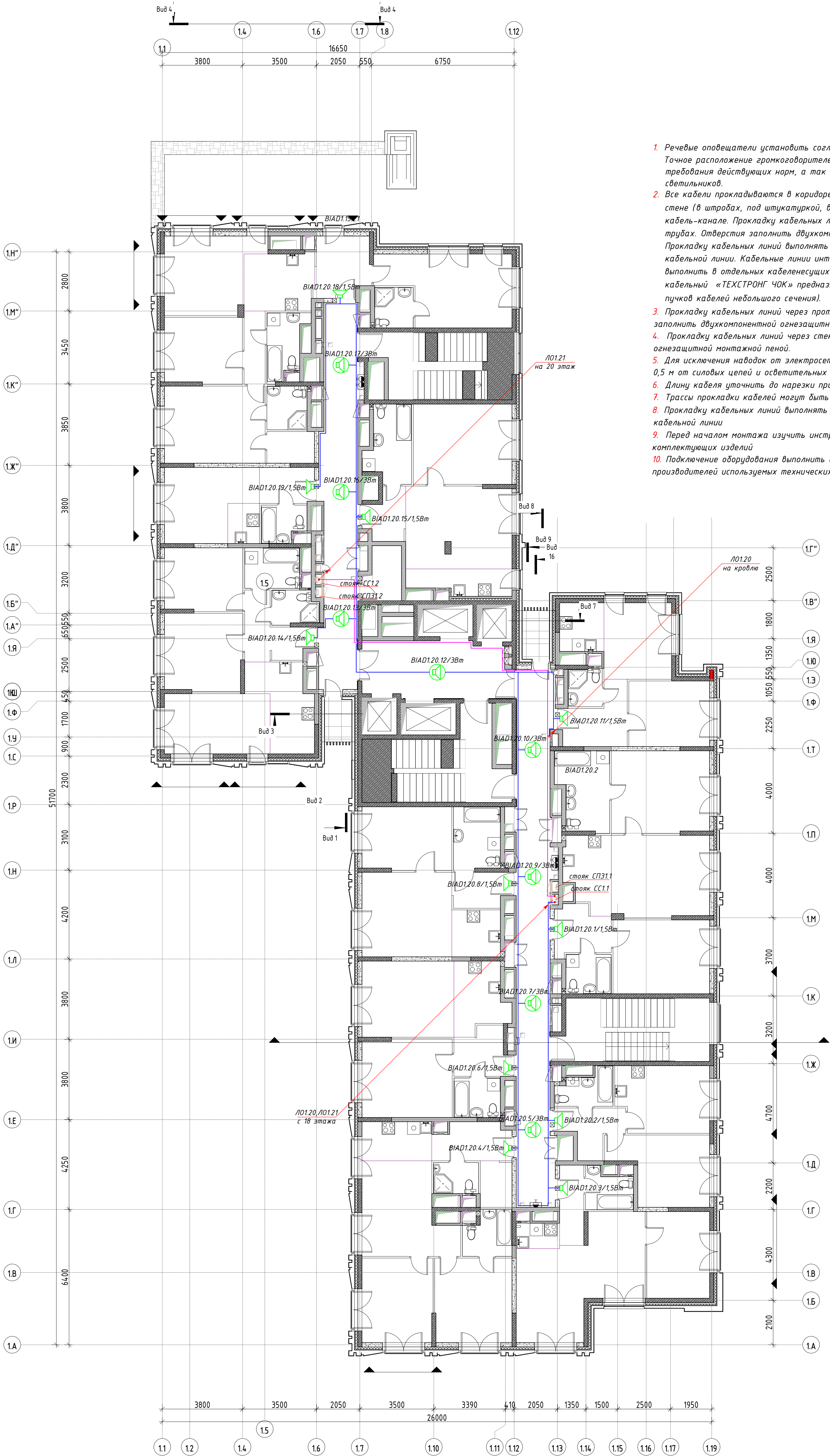
Типовой эскиз заполнения стойка СС 1.1 кабельными трассами
