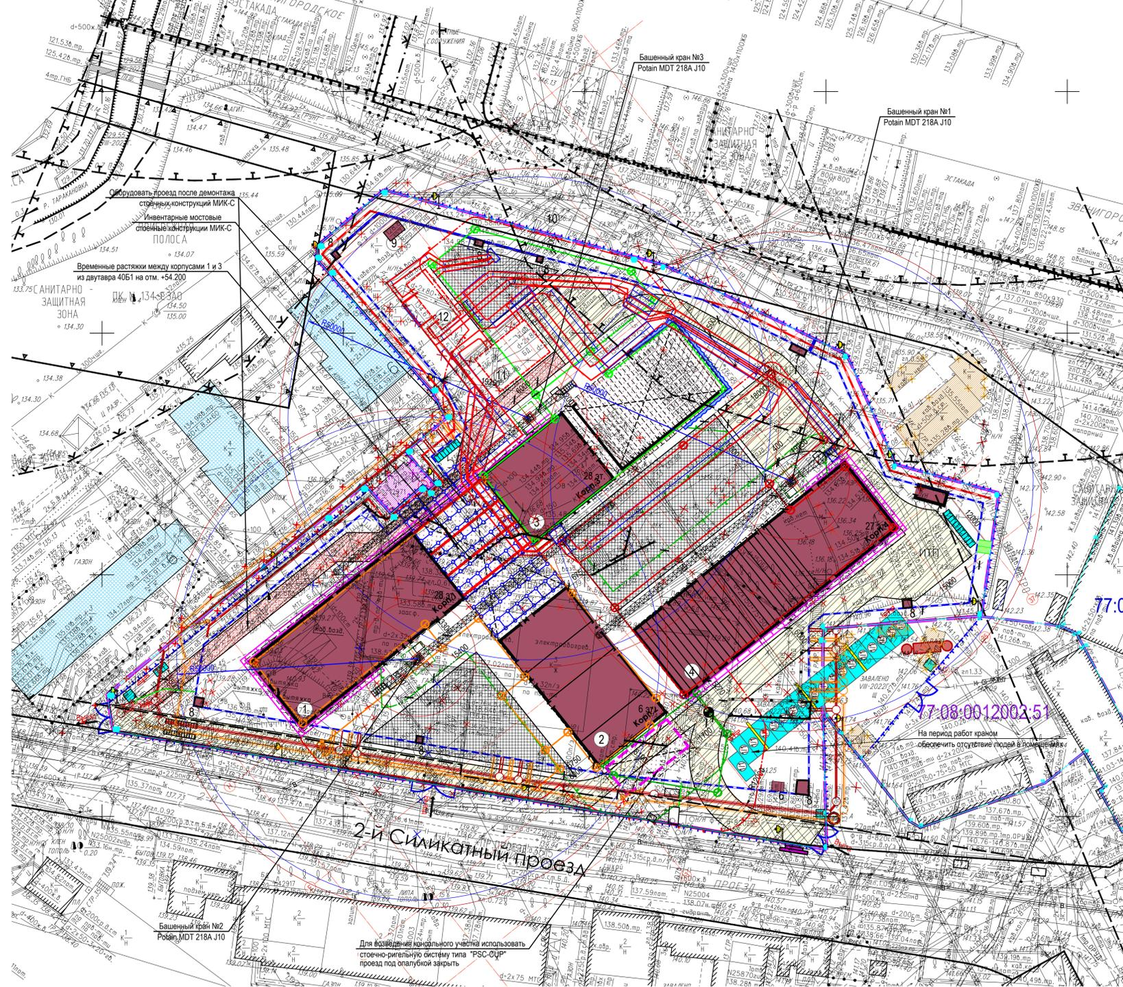
Схема временной автомобильной дороги с двусторонним движением
