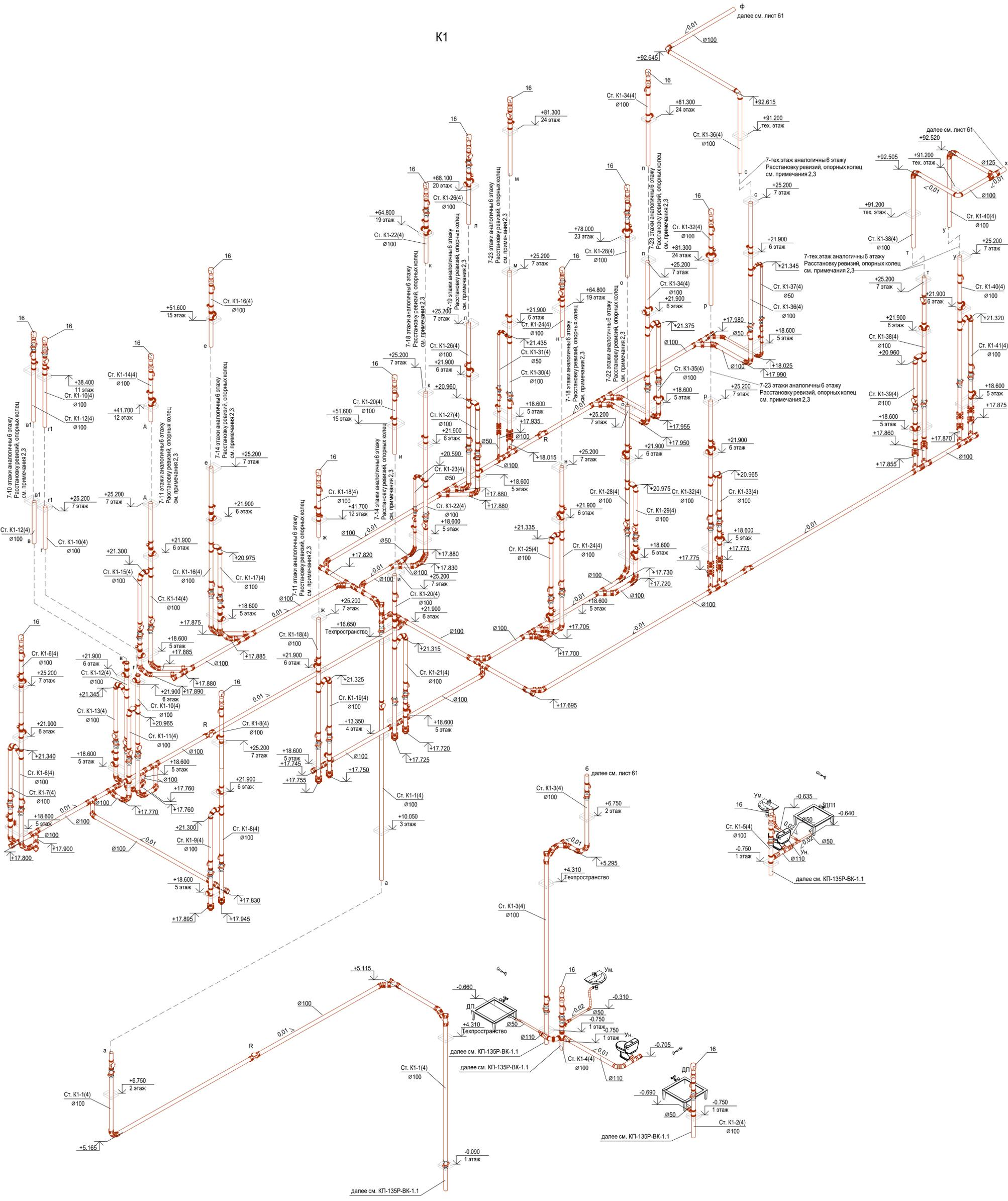
1. Отметки трубопроводов указаны по лотку трубы, относительно отметки 0,000. Уточнить по месту
