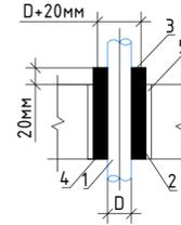
Узел прохода труб через стены
