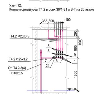
1. Отметки указаны по оси трубопроводов относительно отм.0.000. Отметки уточнить по месту
