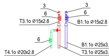
Узел Е. Узел установки неподвижных опор
