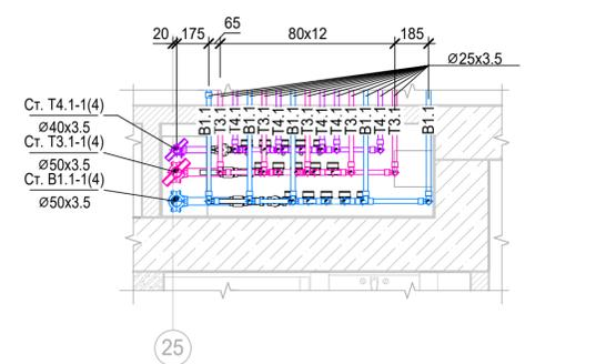
Фрагмент 12. План 5-7 этажей между осями Г и 28 с системами водоснабжения
