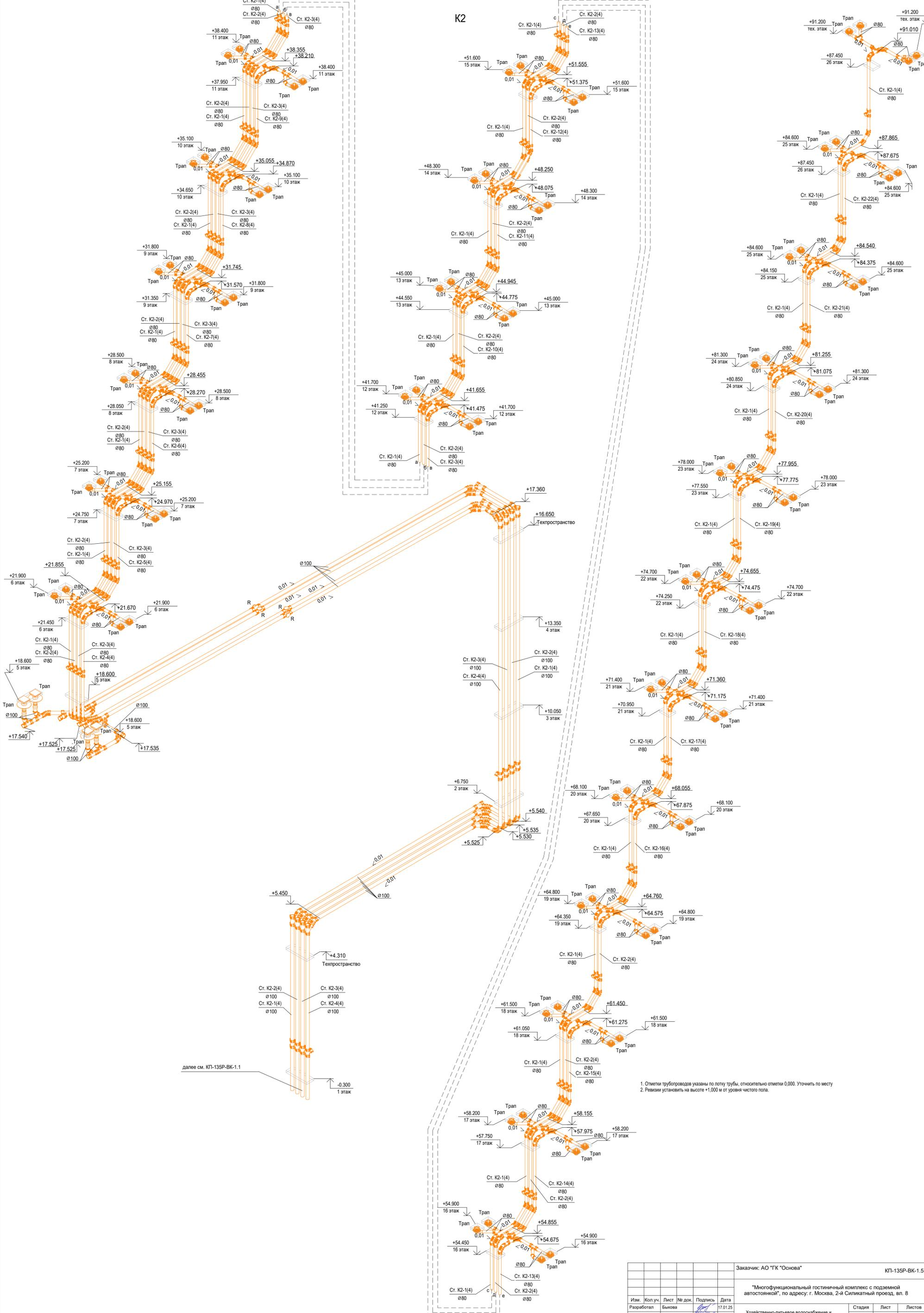
1. Отметки трубопроводов указаны по лотку трубы, относительно отметки 0,000. Уточнить по месту
