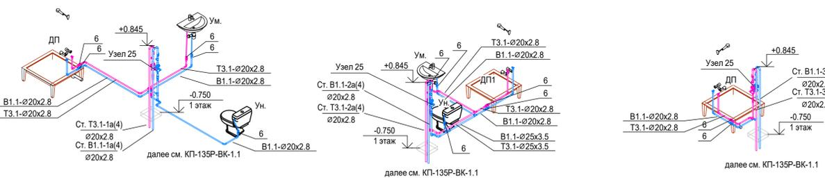
1. Отметки указаны по оси трубопроводов относительно отм.0,000. Отметки уточнить по месту
