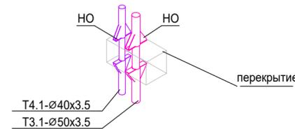
Узел А. Узел ввода систем В1.2, Т3.2 в квартиры 14 - 26 этажа
