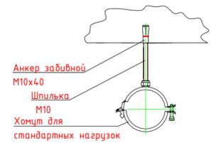
Примечание: расстояние между опорами выбирается в зависимости от диаметра трубопровода согласно СП 73.13330.2016.
