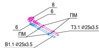
Узел Д. Установка автоматического воздухоотводчика. Закольцовка систем Т3.1о и Т4.1о
