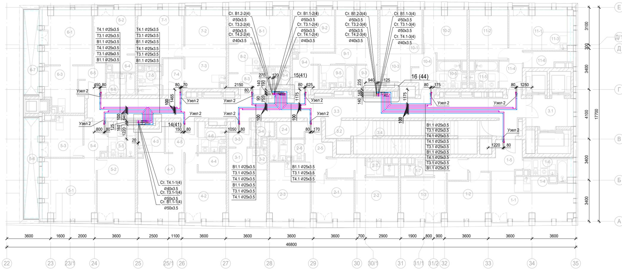
Фрагмент 16. План 11-14 этажей между осями Г и 30/1 с системами водоснабжения
