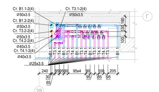
Фрагмент 13. План 5-10 этажей между осями Г и 30/1 с системами водоснабжения
