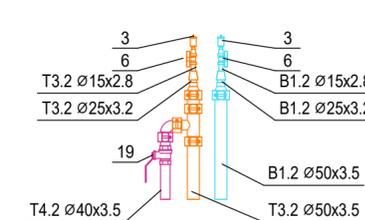
Узел Г. Установка автоматического воздухоотводчика. Закольцовка систем Т3.1 и Т4.1
