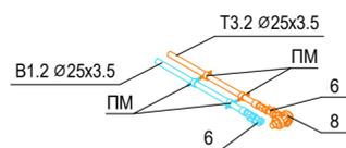
Узел Б. Установка автоматического воздухоотводчика. Закольцовка систем Т3.2 и Т4.2
