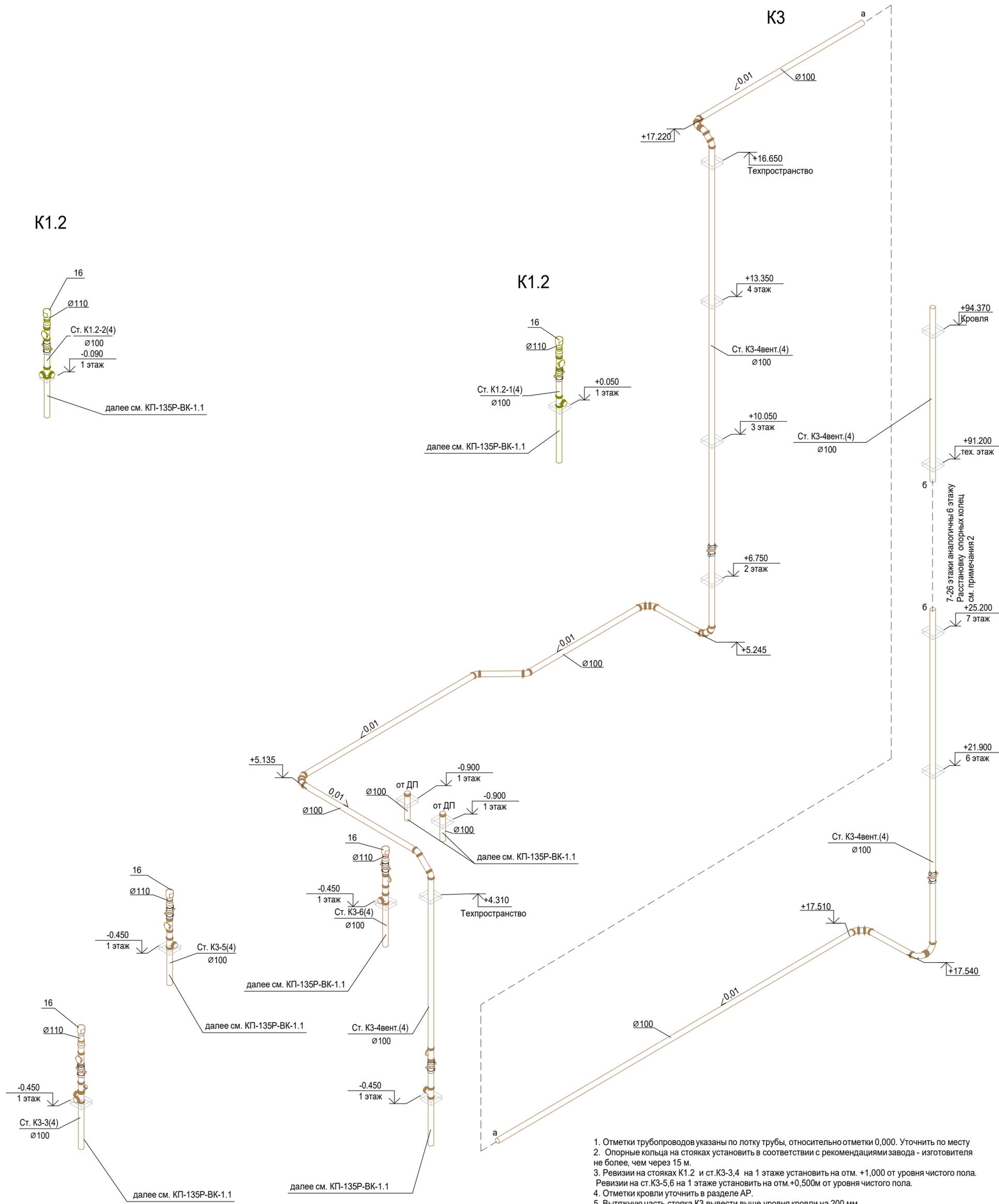
1. Отметки трубопроводов указаны по лотку трубы, относительно отметки 0,000. Уточнить по месту
