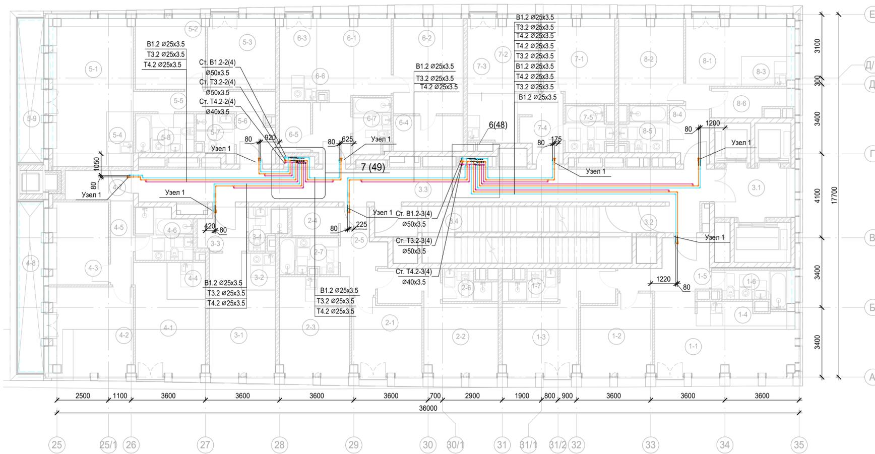
Фрагмент 7. План 16 этажа между осями 28 и Г с системами водоснабжения
