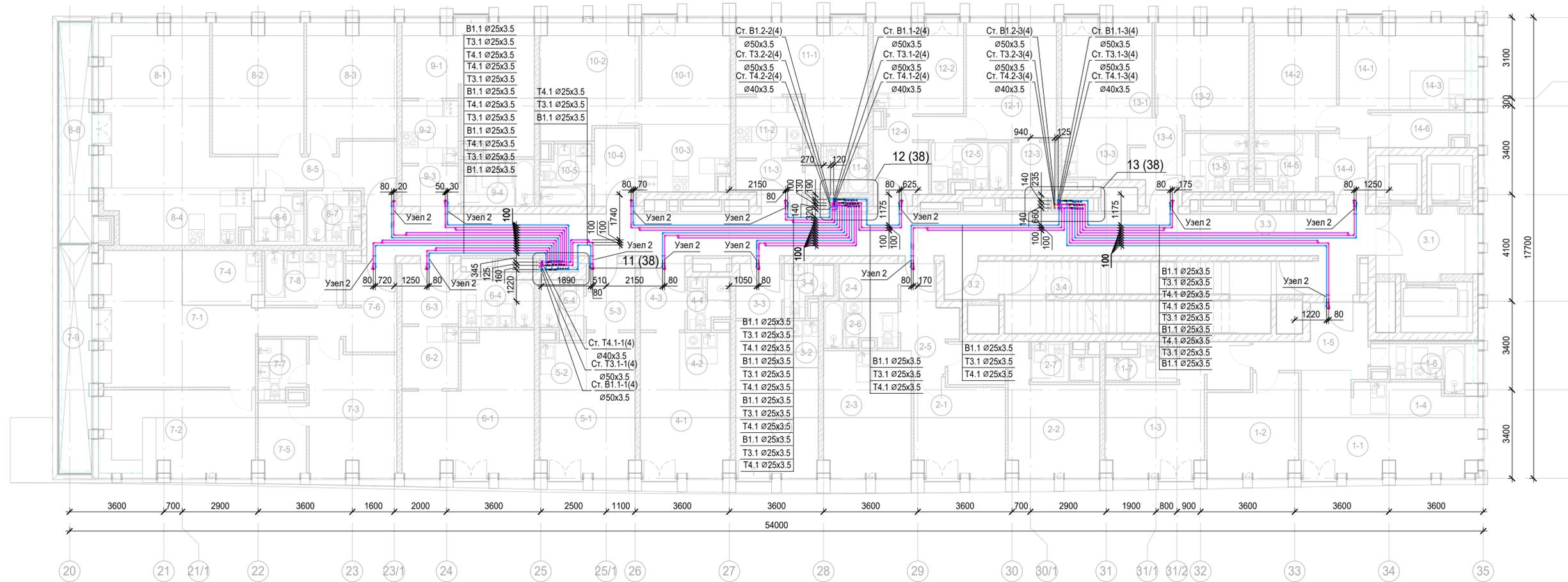
Фрагмент 11. План 5-7 этажей между осями В и 25 с системами водоснабжения
