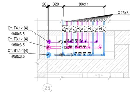
Фрагмент 15. План 8-14 этажей между осями Г и 28 с системами водоснабжения
