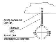
Примечание: расстояние между опорами выбирается в зависимости от диаметра трубопровода согласно СП 73.13330.2016.
