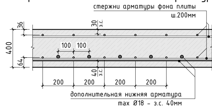
Схема раскладки стержней фоновой и дополнительной арматуры
