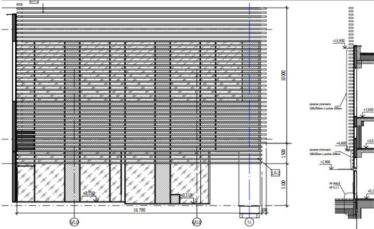
**ЛАМЕЛИ 200мм\*50мм.; 100мм\*50мм., КОРПУС 1,2,3,4**
