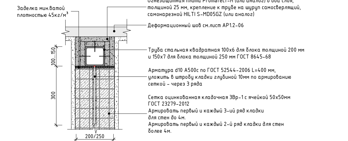
Схема усиления деформационного шва
