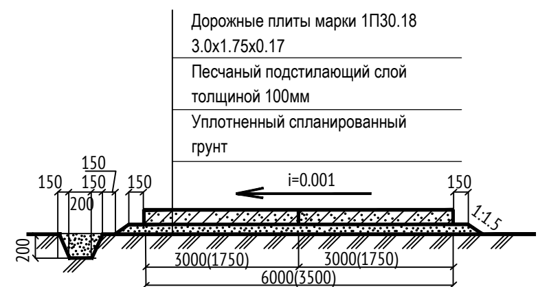
КОНСТРУКЦИЯ АВТОДОРОГИ С ПОКРЫТИЕМ ИЗ ДОРОЖНЫХ ПЛИТ
