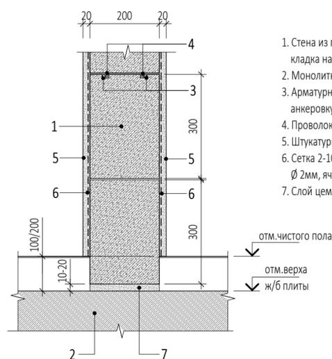
1. Стена из газобетонных блоков D600 ГОСТ 31360-2007, кладка на клей для газобетонных блоков - 200мм
