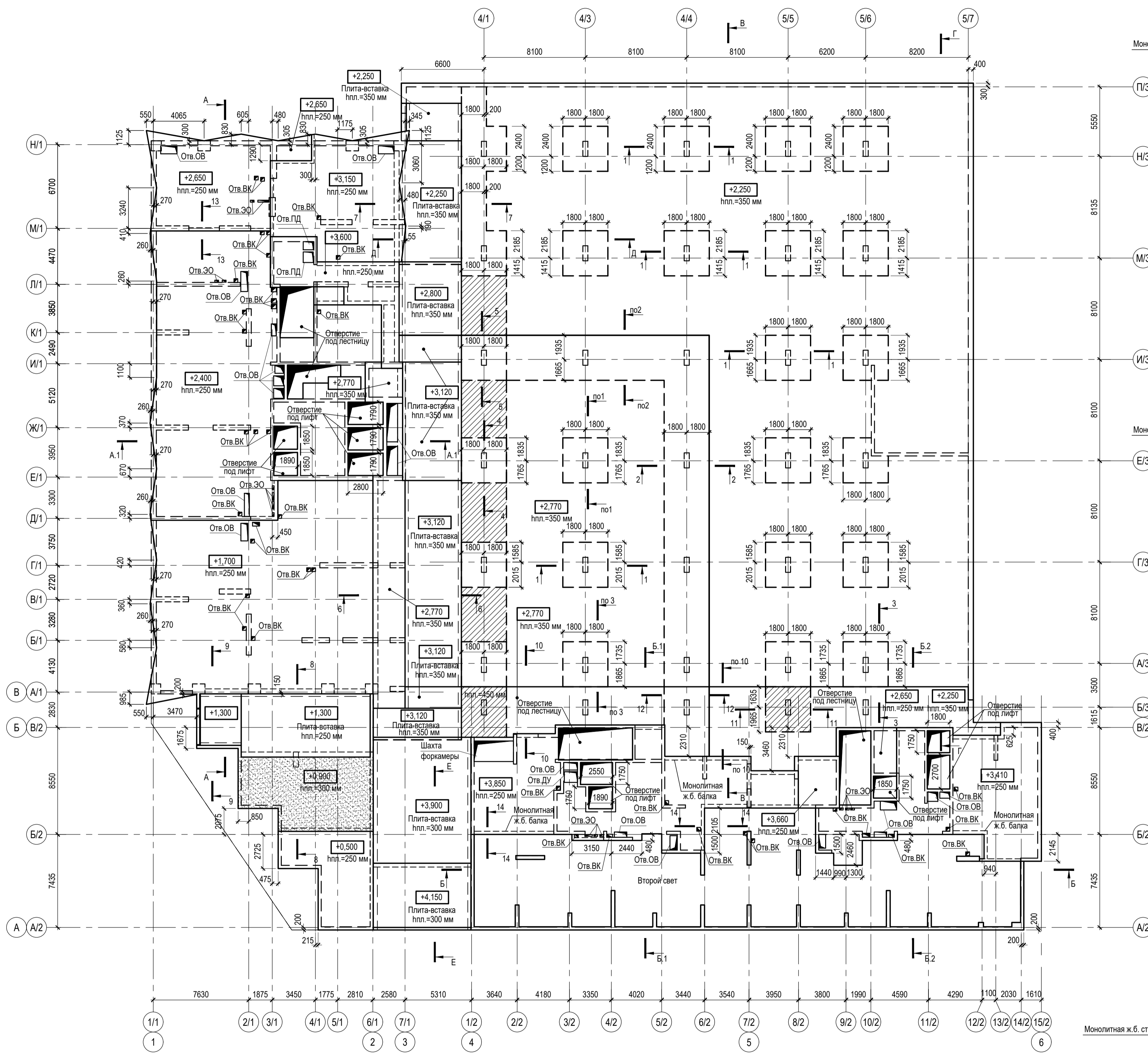
Схема расположения плиты перекрытия над -1-м этажом.
