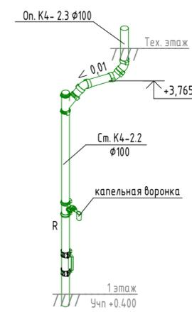
Схема систем канализации K2, K4 в осях 13/1.0-15/1.0 / Ж/1.0-К/1.0
