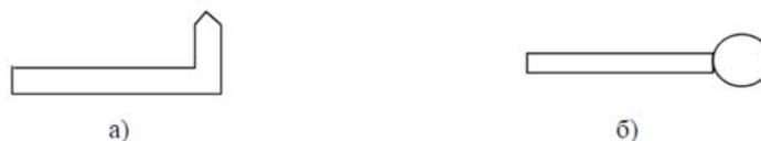
Рисунок 2 - Конструкция осадочной марки
