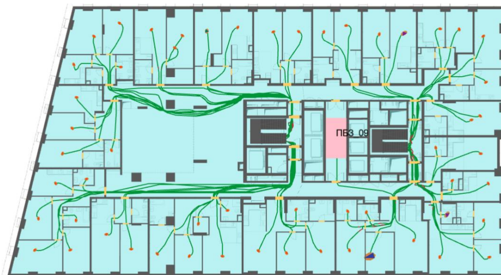
Рисунок 250 – План техпространства на отм. +30.900 и нанесенная на него расчетная (принципиальная) схема эвакуации
