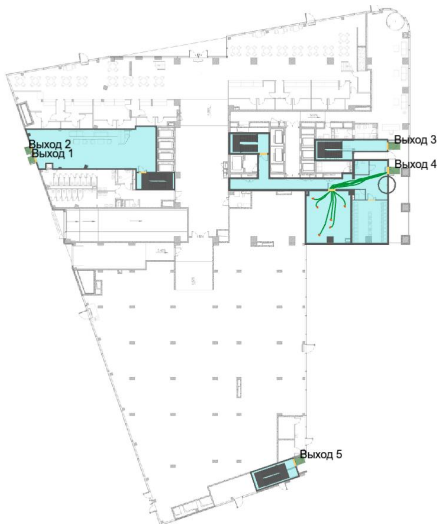
Рисунок 165 – План 1-го этажа и нанесенная на него расчетная (принципиальная) схема эвакуации
