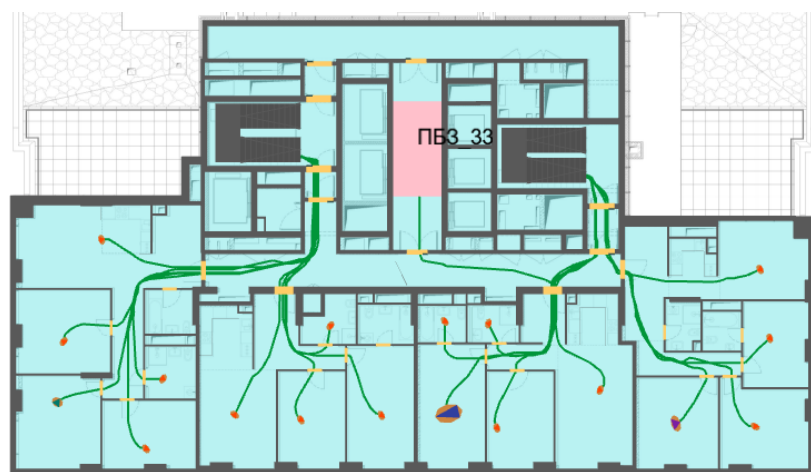
Рисунок 541 – План 33-го этажа и нанесенная на него расчетная (принципиальная) схема эвакуации
