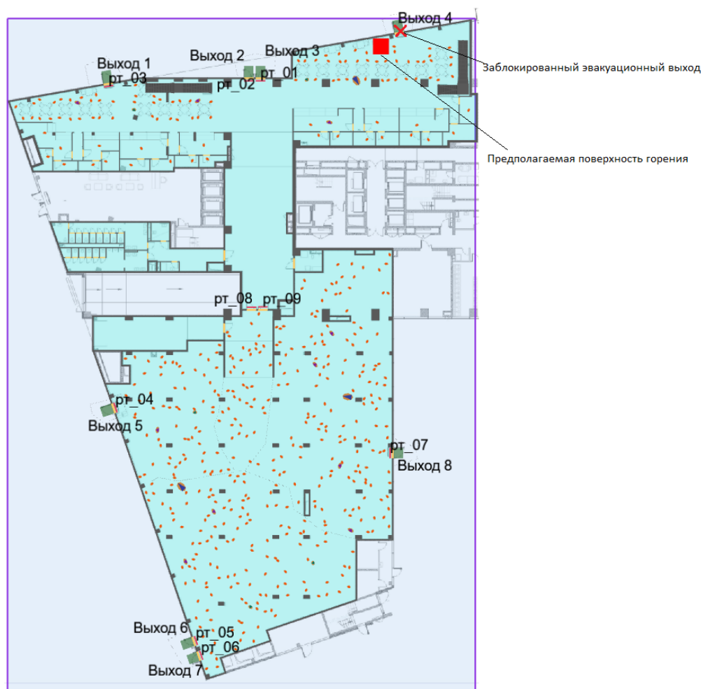
Рисунок: 352 – Компьютерная модель 1-го этажа с предполагаемой поверхностью горения и нанесенными расчётными точками
