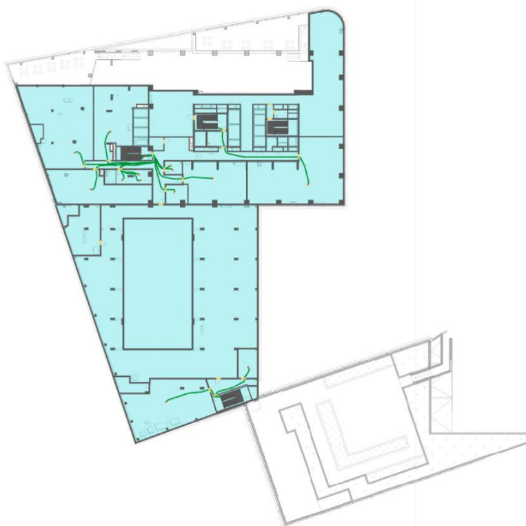
Рисунок 528 – План 2-го этажа и нанесенная на него расчетная (принципиальная) схема эвакуации
