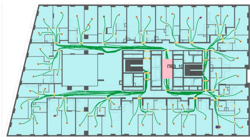
Рисунок 252 – План 10-го – 13-го этажа и нанесенная на него расчетная (принципиальная) схема эвакуации
