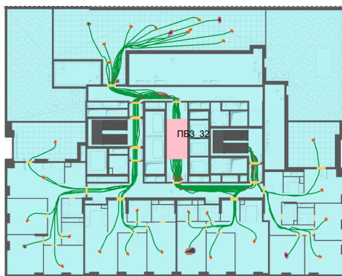
Рисунок 540 – План 32-го этажа и нанесенная на него расчетная (принципиальная) схема эвакуации
