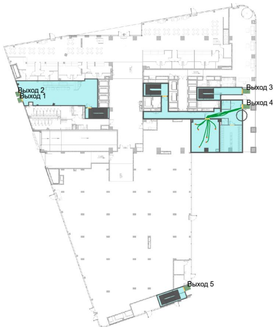
Рисунок 323 – План 1-го этажа и нанесенная на него расчетная (принципиальная) схема эвакуации
