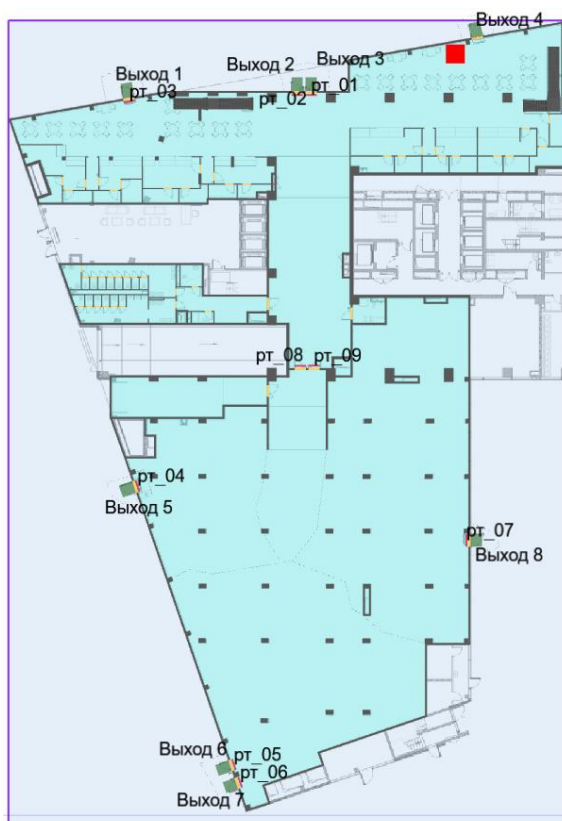
Рисунок 410 – План 1-го этажа и нанесенная на него расчетная (принципиальная) схема эвакуации (расположение людей на момент полной эвакуации с этажа пожара – 2 мин. 53 сек.)
