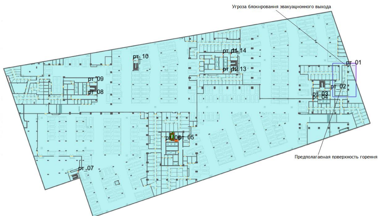
Рисунок 445 – План минус 2-го этажа и нанесенная на него расчетная (принципиальная) схема эвакуации (расположение людей на момент полной эвакуации с этажа пожара – 4 мин.59 сек.)
