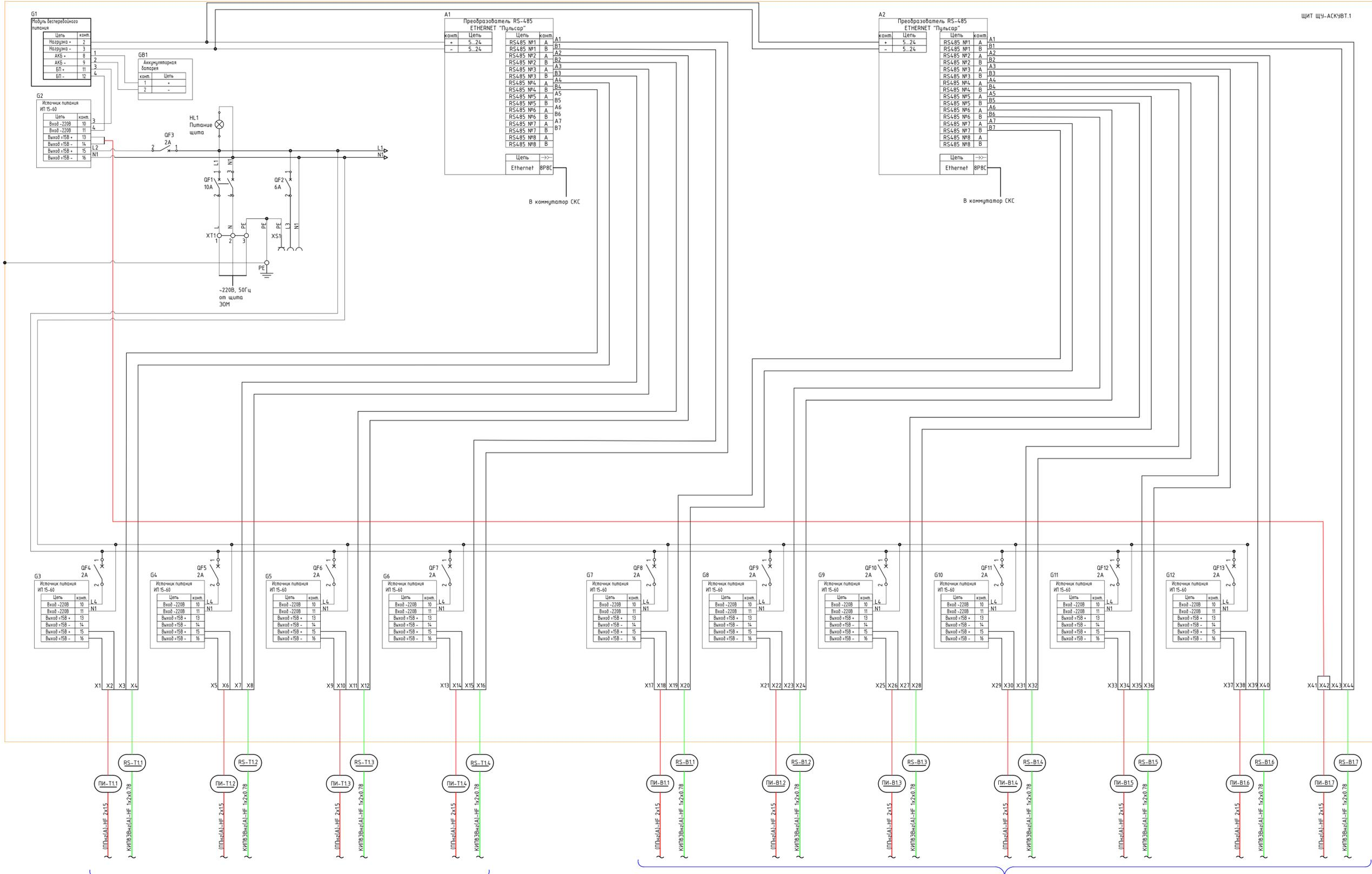
к счетчикам теплоснабжения с интерфейсом RS 485 (смотри в раздел ГКО-1021/24-АСКУТ)
