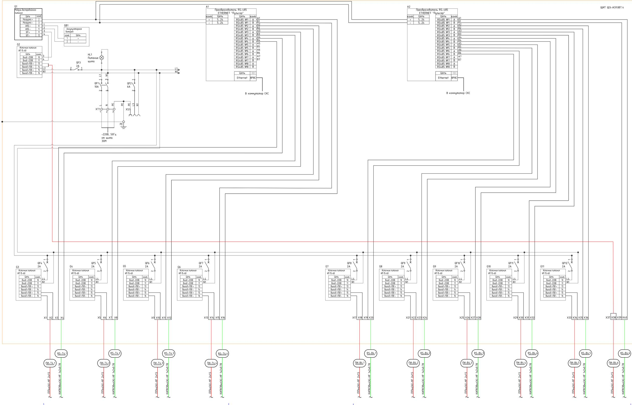
к счетчикам теплоснабжения с интерфейсом RS 485 (смотри в раздел ГКО-1021/24-АСКЧТ)
