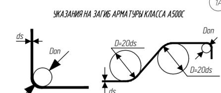
Параметры обработки стержней из арматуры класса А240 и А500С
