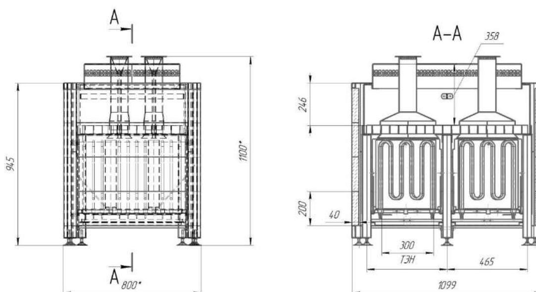
Рис. 1 Внешний вид Устройства при двухсекционном исполнении
