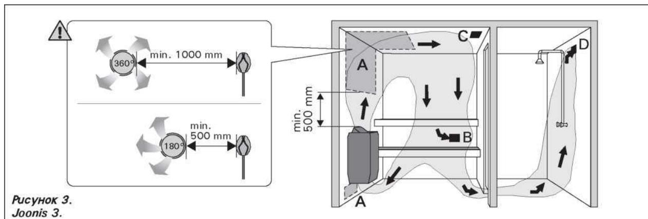
А. Размещение приточного вентиляционного отверстия. Если используется механическая вентиляция, поместите вентиляционное отверстие над каменкой. Если вентиляция естественная, поместите вентиляционное отверстие под или рядом с каменкой. Диаметр трубы для притока воздуха должен быть 50-100 мм. Вентиляционное окно не должно охлаждать температурный датчик (>3.3.1.)!
