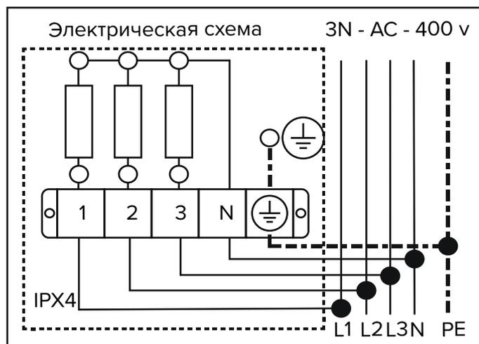
Схема подключения электрокаменки прикреплена к задней панели печи и соответствует данной иллюстрации.
