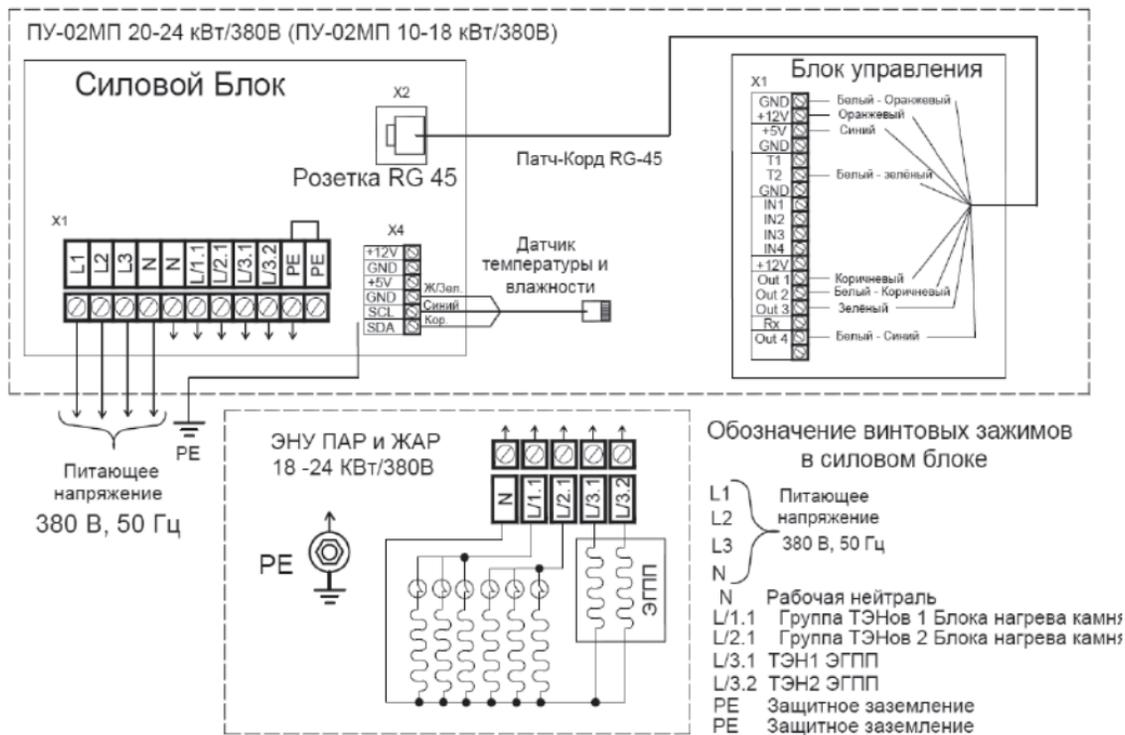
Рис. 6.8.1 Схема электрических соединений ЭНУ и ПУ 18,0-24,0 кВт/ 380В для пультa с трёхпроводным датчиком
