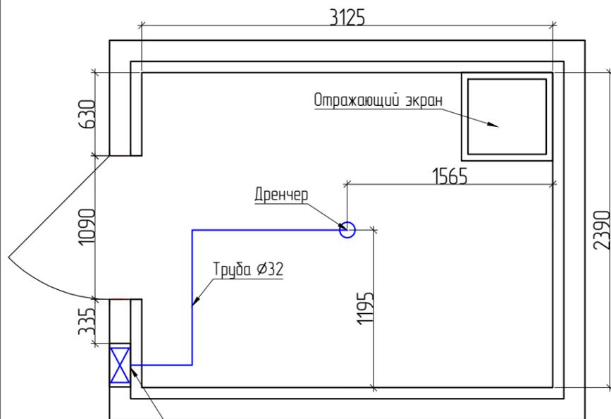
Труба в стене ХВС с краном в лючке на фасаде на высоте 1500 мм от пола для дренчеров (Размеры лючка согласовать)
