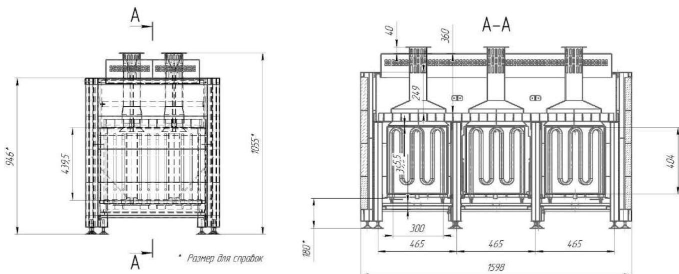
Рис. 2 Внешний вид Устройства при трехсекционном исполнении
