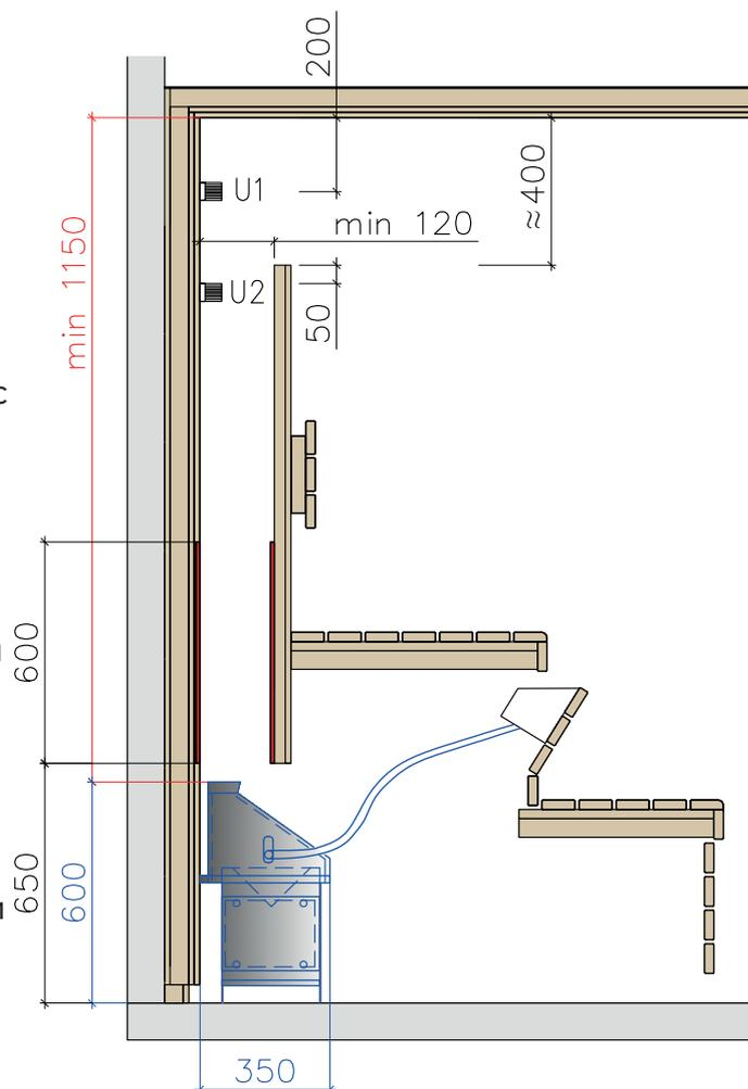
19. В каждой кабине сауны должна быть предусмотрены приточная и вытяжная вентиляция. Приточная вентиляция всегда должна располагаться за каменкой и примерно на 5-10 см над полом.
