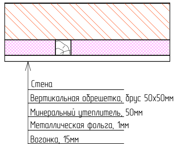
Узел отделки стен
