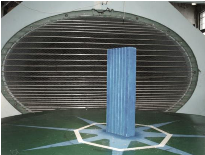
Рис. А.2 Контрольная модель на рабочем столе в аэродинамической трубе А-6 (на заднем плане – двухслойный экран переменной воздухопроницаемости для формирования неравномерного по высоте профиля скорости потока)
